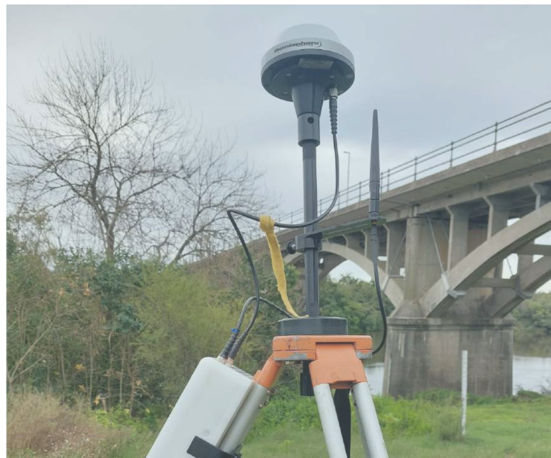
FIGURA 6 - Equipo de GPS para Aforo en Estación N° 141.0 - Queguay Pte. R-3 río Queguay Grande, Departamento de Paysandú, Cuenca 1.
